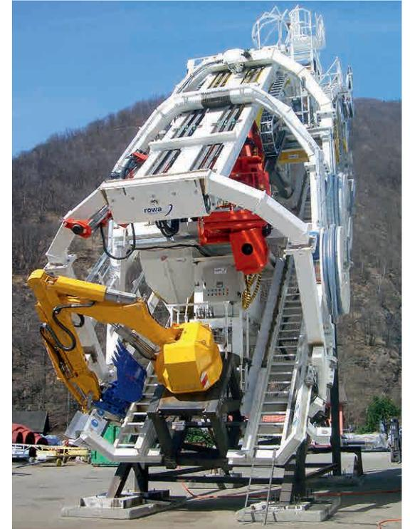
Impiego di una particolare costruzione per lo spostamento di condotte forzate
